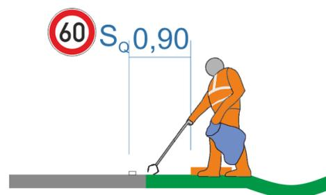
Abb. 5 Sonderfall für  $S_Q$  bei Arbeiten außerhalb der befestigten Straßenfläche mit Abfallgreifzange
