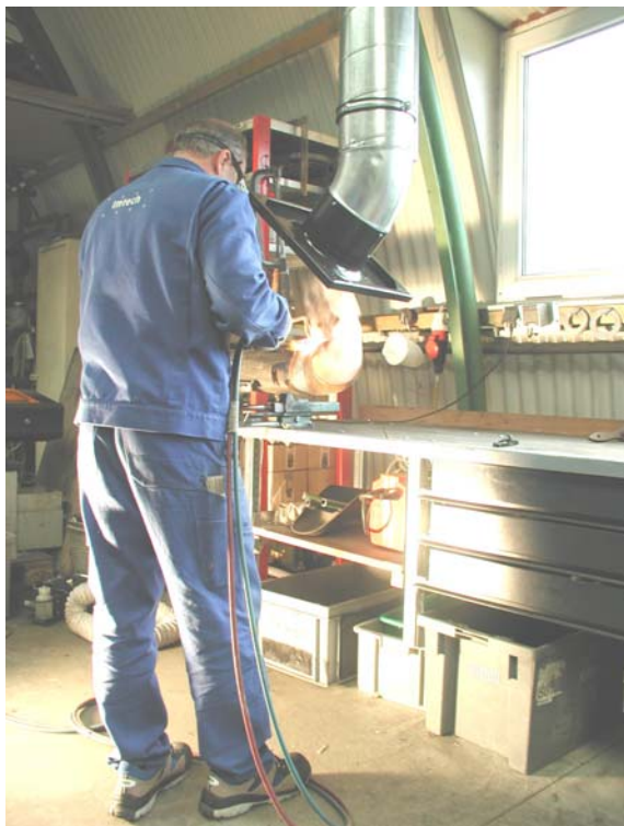
Abb.: Beispiel für eine Erfassungseinrichtung mit Düsenplatte (Quelle: WISAG, vormals ThyssenKrupp HiServ)
