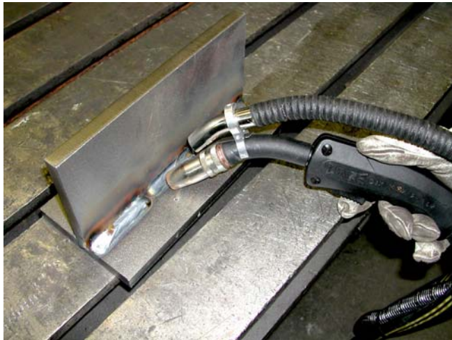
Abb.: Beispiel für einen Schweißbrenner mit integrierter Absaugung
