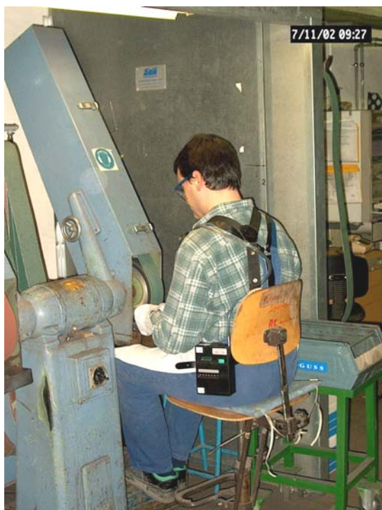
Abb.: Erfassungseinrichtung an einem Bandschleifer
